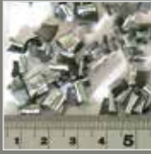
強力缺削斷屑狀況
