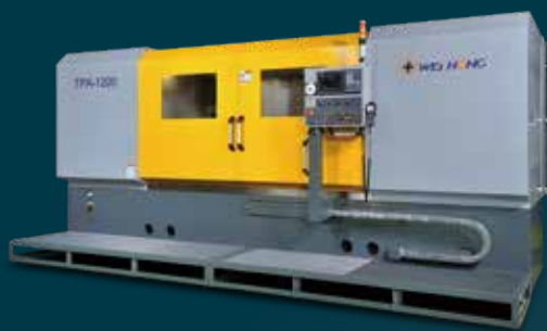
環鋸留芯鑽孔加工
